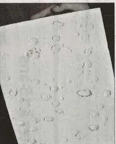
La plaque témoin de la station de Volnay montre les impacts de grêle. Photo F. Bassoleil
