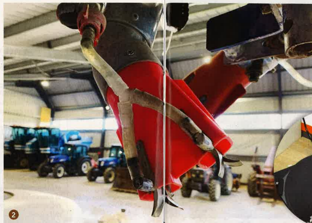
1 MIKAEL BOUSCARI, vigneron héraultais, fabrique des pièces, comme cette main de pulvérisateur 2 avec une simple imprimante 3D 3 du commerce. DR
