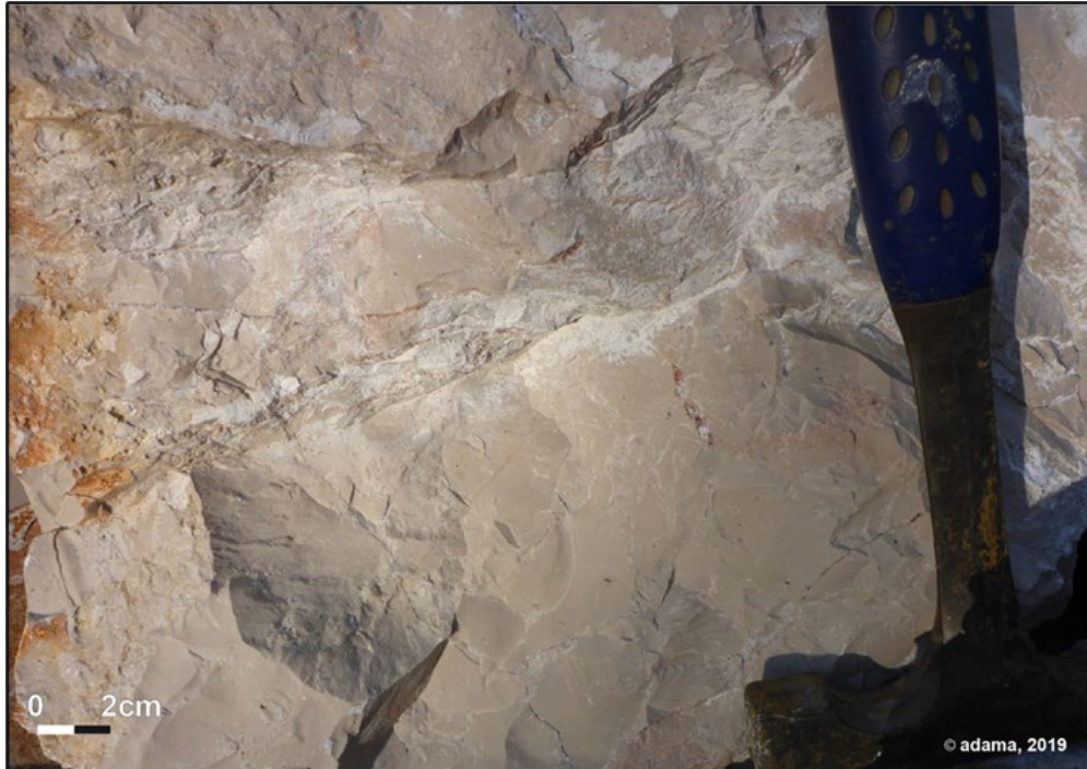
Figure 32. Faciès homogène à pâte très fine, avec une cassure d’aspect porcelané, d’un bloc de Calcaires de Comblanchien
