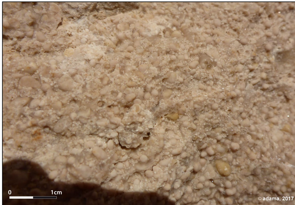
Figure 29. Détail d'un morceau d'Oolithe Blanche montrant des oolithes de différentes tailles cimentées par des cristaux de calcite
