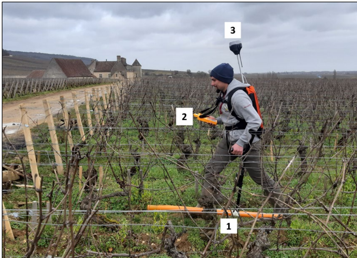
Figure 44. Dispositif d'acquisition géophysique : conductivimètre (1), datalogger (2) et GPS différentiel (3)
